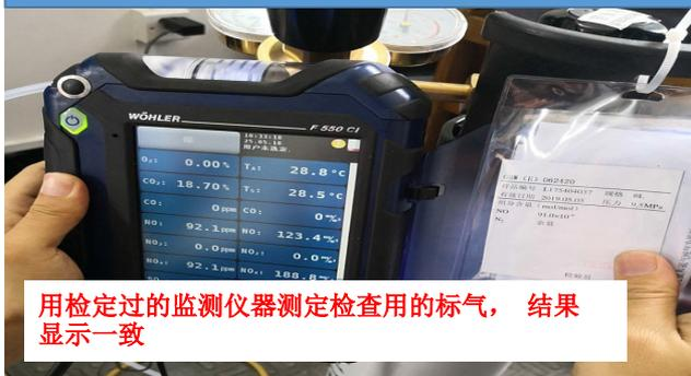
用检定过的监测仪器测定检查用的标气，结果显示一致
